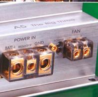
Single: Der einzelne Netztrafo versorgt die DLS A5 mit satter Power (oberes Bild). Der "Fan"-Anschluss (unteres Bild) ermöglicht das Andocken eines Lüfters. um die Schwedin bei Bedarf zu kühlen.
